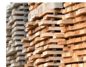
乾燥機にて乾燥させる製材原盤
