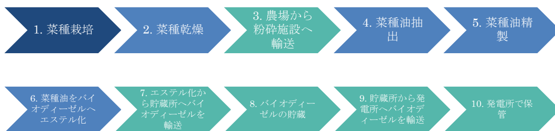
図 7：菜種バイオディーゼルを使用した燃料連鎖構造の例 (凡例 - ダークブルー：栽培、青：加工、青緑：輸送と流通)
